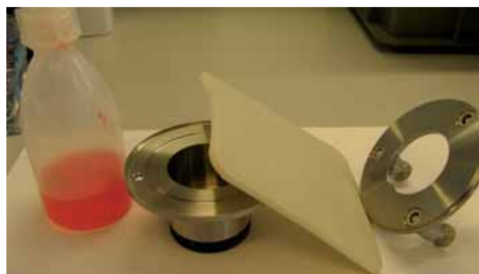
Abb. 1: Der Paddington Cup, künstliches Wundexsudat und zu prüfende Wundauflage
